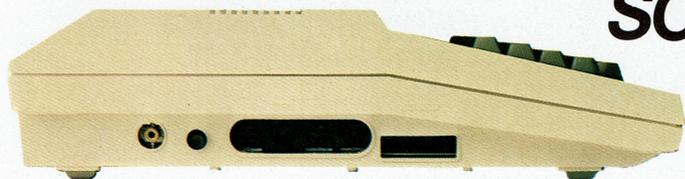
Gracias a su salida paralelo Centronics, el Dragón 32 permite la conexión con la práctica totalidad de impresoras y otros periféricos como plotters, máquinas de escribir eléctricas, etc.
